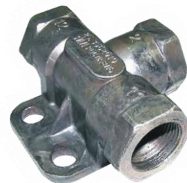
ДВУМАГИСТРАЛЬНЫЙ КЛАПАН ПРЕДНАЗНАЧЕН ДЛЯ УПРАВЛЕНИЯ ОДНОЙ ТОРМОЗНОЙ МАГИСТРАЛЬЮ ОТ ДВУХ ДРУГИХ
