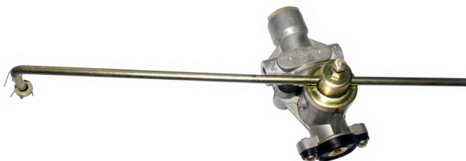
РЕГУЛЯТОР УРОВНЯ ПОЛА ПРЕДНАЗНАЧЕН ДЛЯ АВТОМАТИЧЕСКОГО УПРАВЛЕНИЯ ПОТОКОМ ВОЗДУХА, ПОСТУПАЮЩЕГО В ПНЕВМОБАЛЛОНЫ ПОДВЕСКИ
