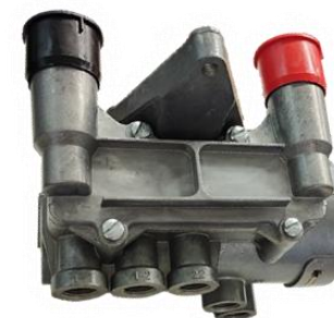
ВОЗДУХОРАСПРЕДЕЛИТЕЛИ С КРАНОМ РАСТОРМАЖИВАНИЯ ПРЕДНАЗНАЧЕНЫ ДЛЯ УПРАВЛЕНИЯ ТОРМОЗАМИ ПРИЦЕПА АВТОТРАНСПОРТНОГО СРЕДСТВА С ДВУХПРОВОДНОЙ ТОРМОЗНОЙ СИСТЕМОЙ
