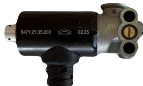
КЛАПАН ЭЛЕКТРОМАГНИТНЫЙ ПРЕДНАЗНАЧЕН ДЛЯ ПОДАЧИ ДАВЛЕНИЯ ВОЗДУХА ИЗ РЕСИВЕРА В РАБОЧУЮ МАГИСТРАЛЬ К ИСПОЛНТЕЛЬНЫМ МЕХАНИЗМАМ
